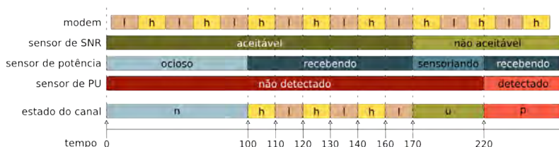
Figure 4. Fusão das séries temporais dos sensores formando a série temporal de estados do canal.
